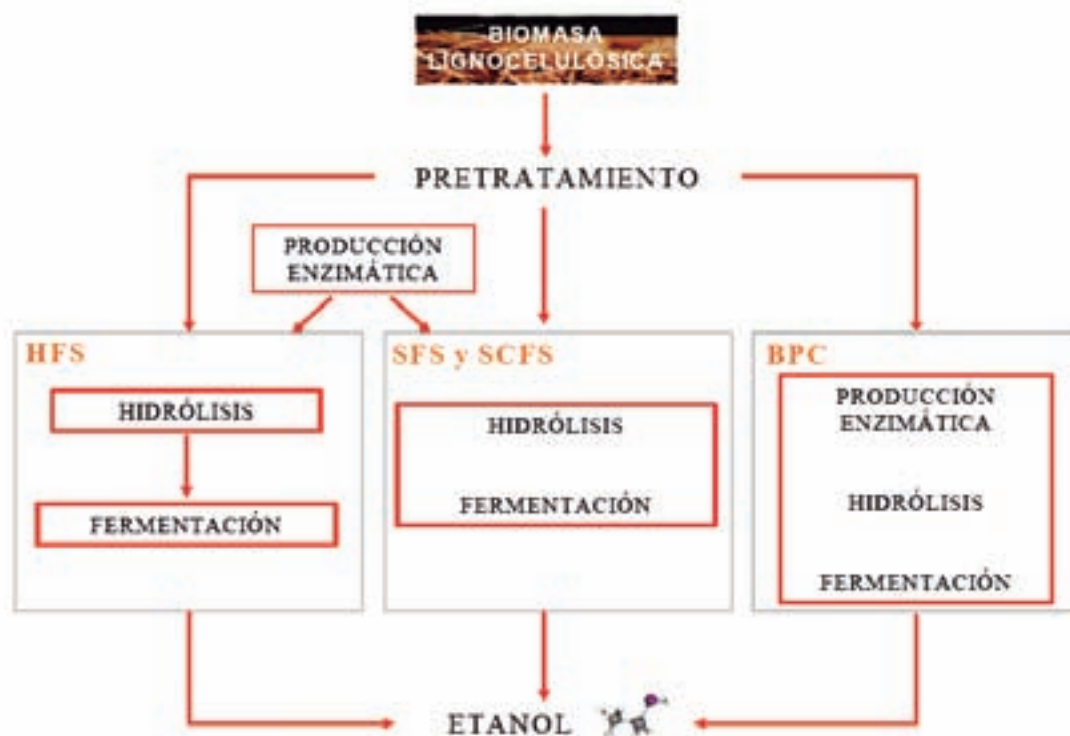
Figura 4.1 Principales configuraciones de procesos en la producción de bioetanol mediante catalizadores enzimáticos a partir de biomasa lignocelulósica
