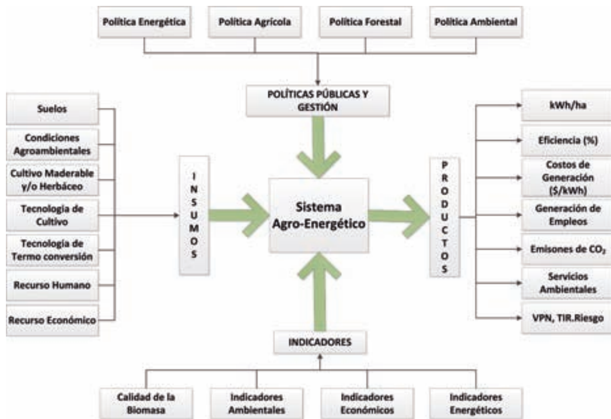
Figura 2.2 Componentes de un Sistema Agro-Energético Fuente: elaboración propia
