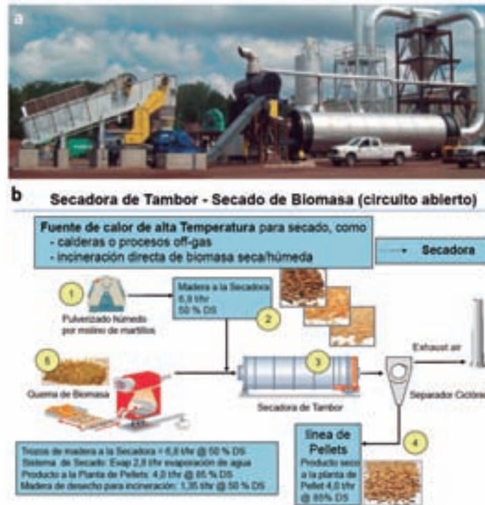
Figura 3.18 Sistema de secado de la biomasa en un secador rotatorio. a) Tecnología de la IAC, b) Secador acoplado a una planta de peletización.
