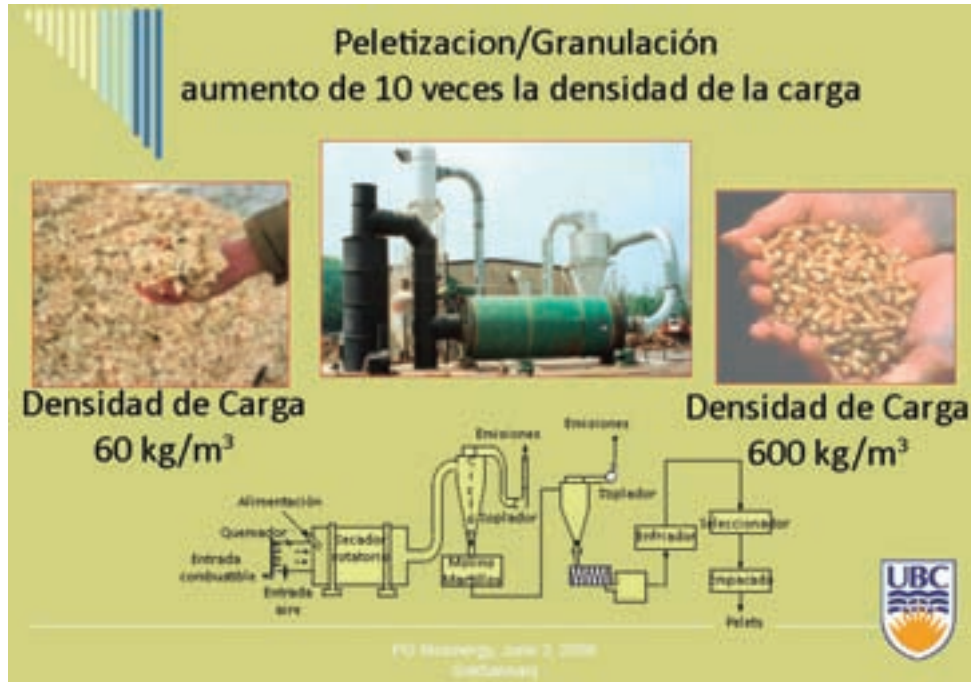
Figura 3.20 Densidad de la biomasa in natura y de los pellets
