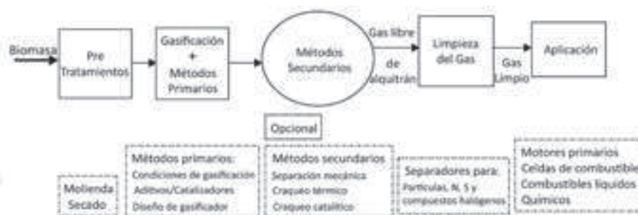
Figura 5.23 Metodos primario y secundario de limpieza del gas
