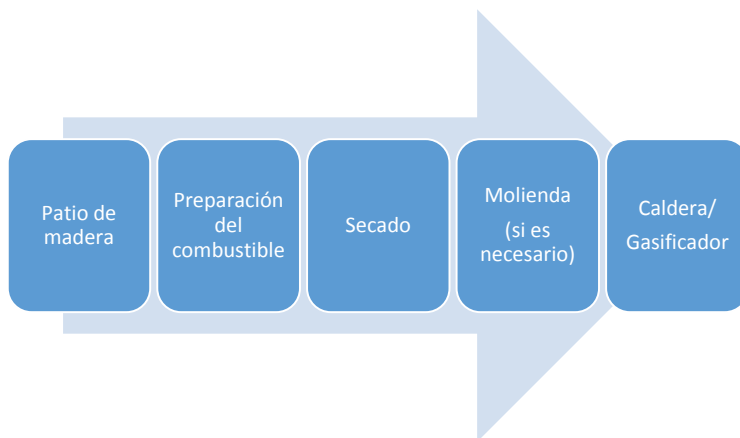
Figura 3.15 Esquema del secado en el proceso de preparación de la biomasa
