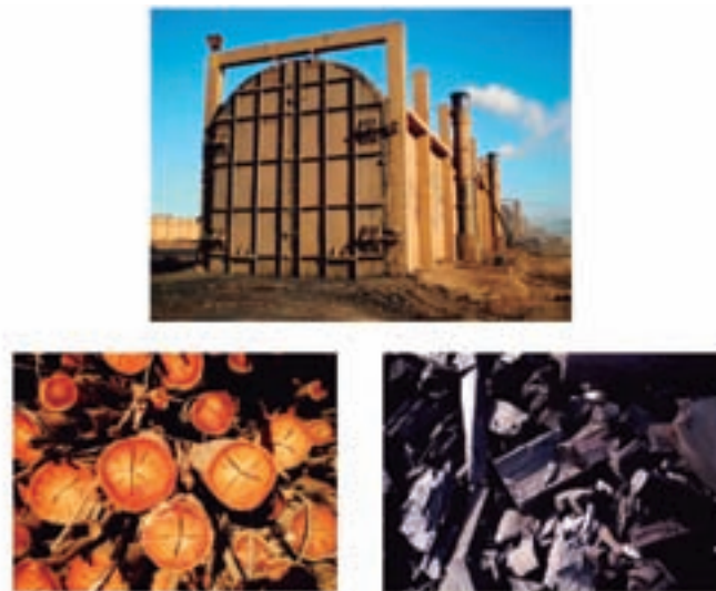
Figura 5.31 Horno de ladrillo rectangular, versión moderna del horno tipo Missouri desarrollada por la empresa Brasileña Acesita. En la parte superior el horno y en la inferior la materia prima (Eucaliptus) y el carbón producido.
