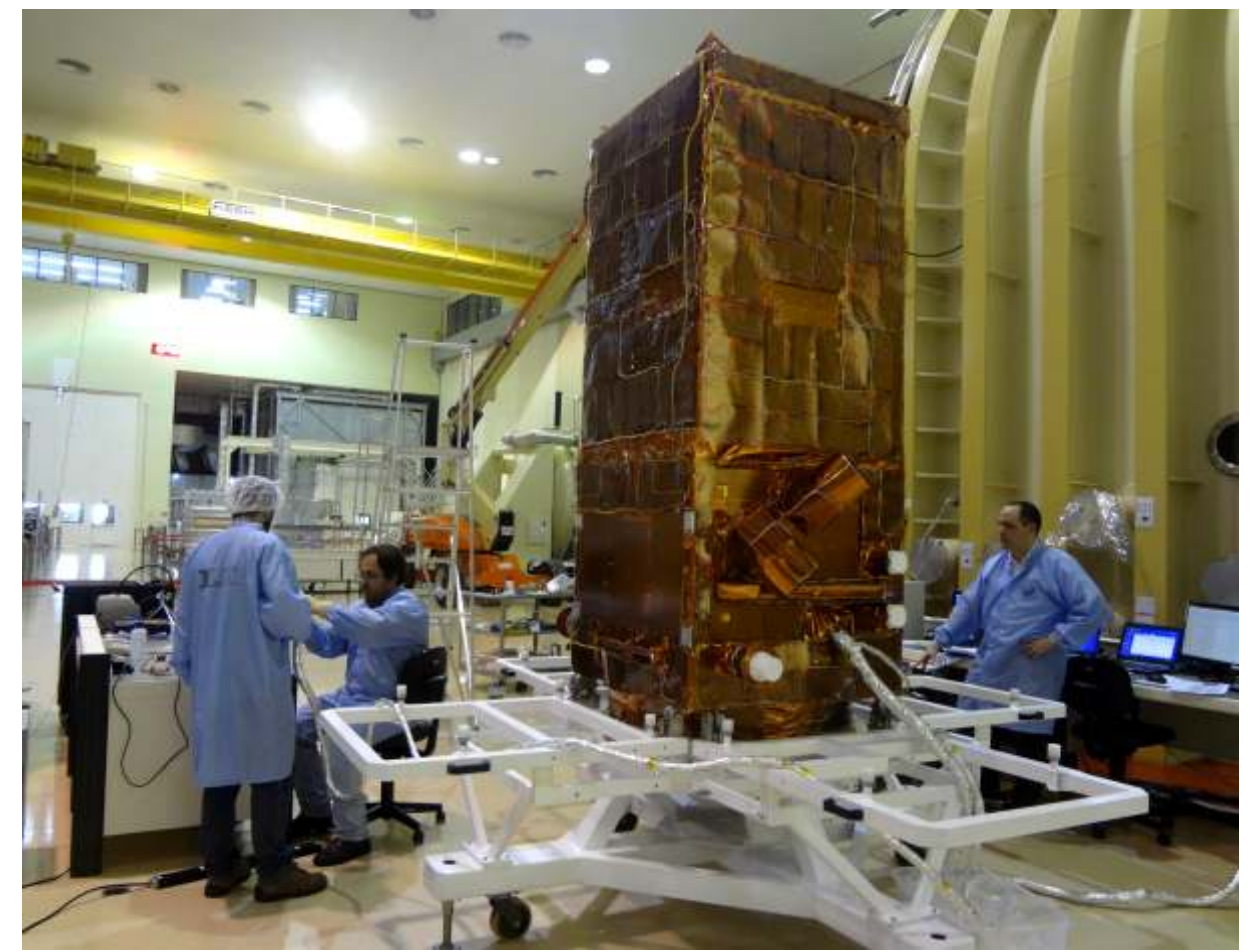
Modelo Térmico do Satélite Amazônia 1 sendo montado no Laboratório de Integração e Testes do Inpe. (Fonte: Inpe, 2015)
