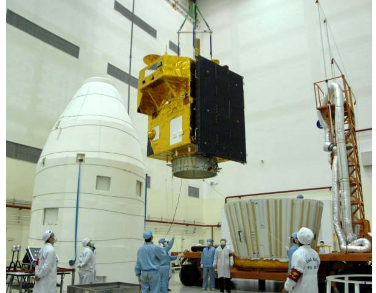
Satélite CBERS 4 sendo colocado na coifa de lançamento do lançador Longa Marcha 4B. (Fonte: Inpe, 2014)
