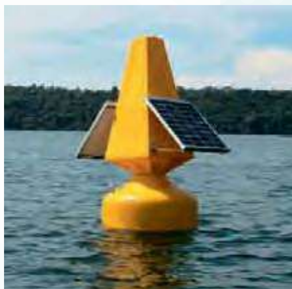
Figura 3a-b. O monitoramento em tempo real é um dos avanços tecnológicos mais importantes na gestão das águas. (Fotografia: Exemplo de plataforma - IIEGA).
