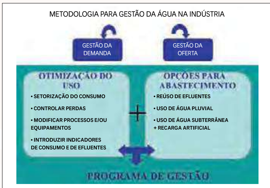
Figura 6. Programa integrado de gestão da água na indústria, através das práticas de conservação e reúso de água (FIESP/CIESP 2004).
